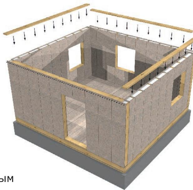
По завершению монтажа стен мансардного этажа устанавливаются мауэрлаты, прогоны и коньки. В конструкции кровли используются усиленные SIP-панели. Сборка конструкции холодной кровли выполняется традиционными методами. Основными используемыми кровельными материалами являются мягкая черепица и металлическая черепица.
