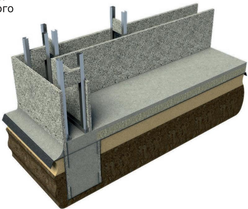
Для обеспечения прочности конструкции рекомендуется устройство несущих армированных колонн (1) с заливкой тяжелым бетоном.
