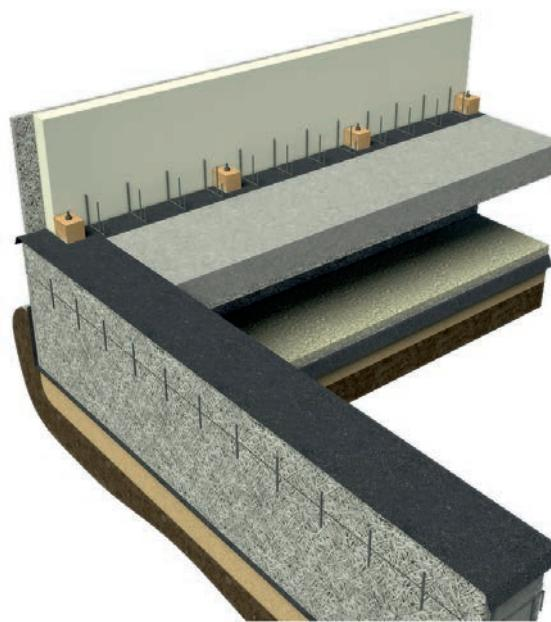
Вторым этапом монтируется внутренняя плита на установленные строительные стяжки, со сдвигом относительно угловых соединений по разметке на фундаменте, как показано на рисунке.
