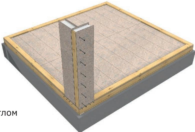
Все соединения выполняются с уплотнением монтажной пеной и собираются с помощью саморезов или специальных гвоздей. Благодаря заранее подготовленным монтажным элементам, удается добиться плотного совмещения панелей. В результате в готовом доме совершенно отсутствуют щели и зазоры. Монтаж стенных панелей достигается с помощью замков типа "шип-паз". После установки стены первого этажа закрепляются верхним обвязочным бруском.
