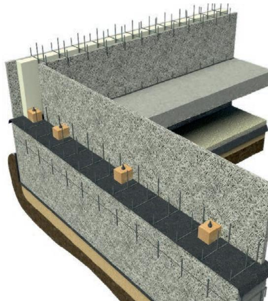
На подготовленный фундамент установить обвязочный брус, согласно разметке, и закрепить. Монтаж вертикальных несущих конструкций начинается с угла. К наружной плите крепятся односторонние строительные стяжки, после чего плита устанавливается стяжками вниз, к брусу, который выполняет функцию направляющего элемента, как показано на рисунке. Одновременно с наружной стороны стены внутри опалубки монтируется утеплитель: пенополистирол или плита GB1.
