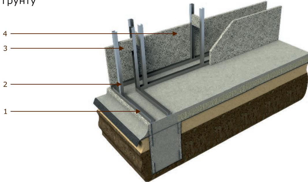
На фундамент, при помощи анкерных болтов, крепятся горизонтальные направляющие профиля ЛСТК (1). Далее, при помощи саморезов, устанавливается вертикальный стоечный профиль ЛСТК (2). Для прочности конструкции монтируются вставки из плиты GB2 (3). В первую очередь выполняется монтаж наружных плит GB600-35 или GB2-35 (4). Плиты крепятся к профилю при помощи саморезов. Далее выполняется монтаж внутренних стен.
