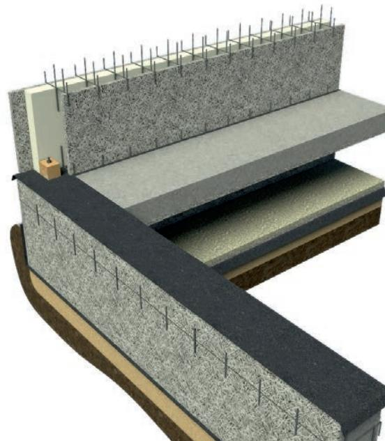
Далее от угла, с прикрепленными односторонними стяжками, к направляющим и по разметке на фундаменте, монтируется внутренняя плита перпендикулярного направления.
