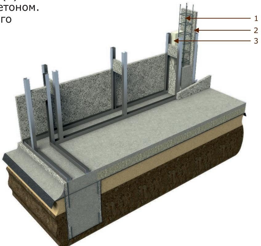
Толщина бетонного ядра, марка и шаг профиля ЛСТК, армирование подлежат расчету согласно проектного решения.
